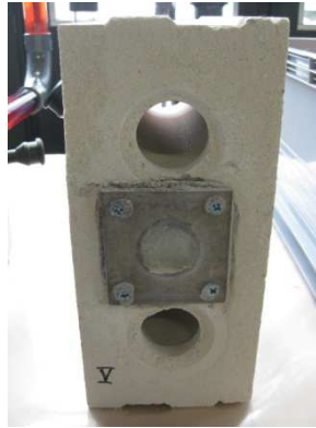
Blick auf die Verschluss-Platte (vollständige Füllung der Kammer).
