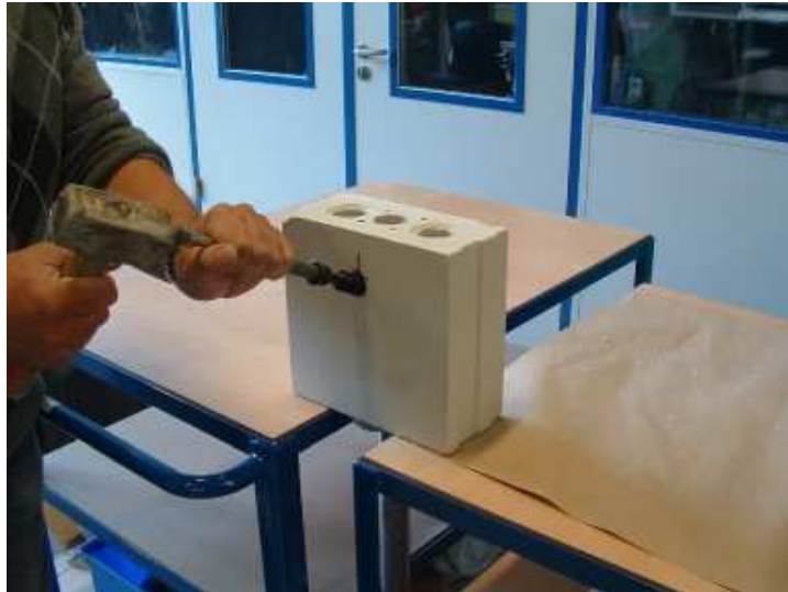
Montage des Packers in der Bohrung unter Verwendung eines Setzwerkzeugs.
