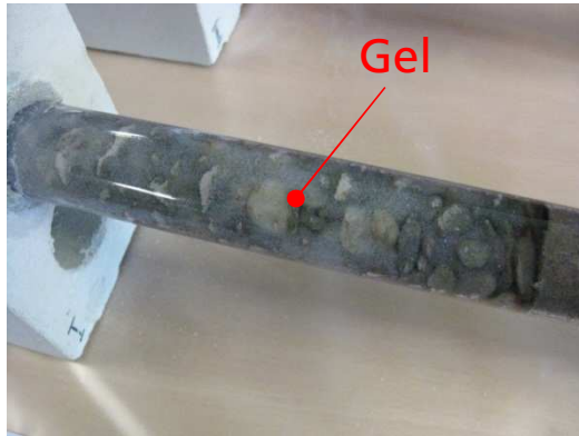
Gelverpressung in die Kiesschüttung hinein.
