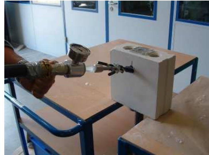
Am Packer aufgesetzte Verpresseinheit (Demonstration). Die Verpressung wurde anschließend bei horizontal liegenden Kammern durchgeführt.
