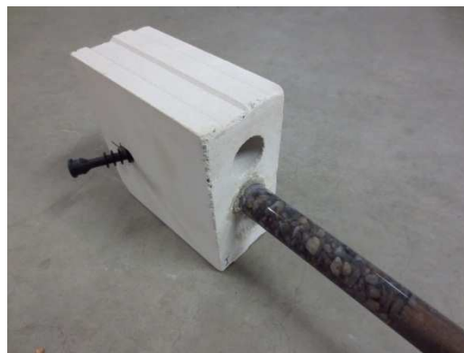
Gesamtansicht (Versuchslaufzeit bisher: 8 Monate, kein Eindringen von Wasser in den Stein).
