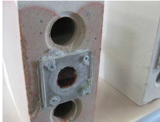
Blick auf die Seite mit der Verschluss-Platte, 15 min nach Versuchsstart.
