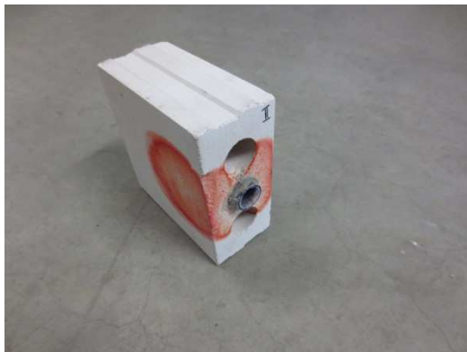
Gesamtansicht nach Versuchsende (Laufzeit: 2 Monate), Blick auf Rohranschluss (bereits entfernt).
