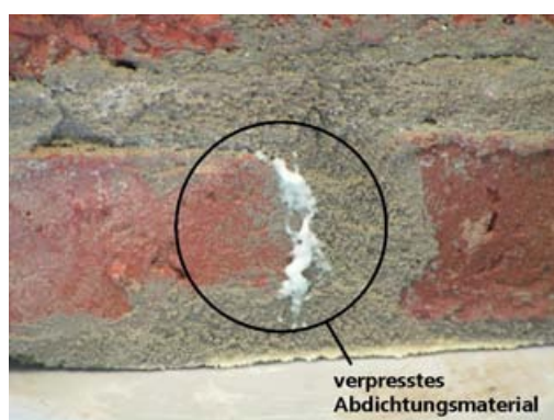
Bild 5.1 Verpressung des Abdichtungsmaterials im Versuch am Mauerblockmodell
